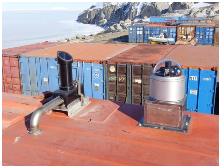
Fig. AZ3.02-2 – A sinistra il VELOD (Vertical looking Device - operativo da Febbraio 2013) ed a destra la piattaforma alt azimut denominata MIGE (Multiple Input Geometry Equipment - setup Novembre 2014). Entrambi i sistemi sono collegati allo spettrometro via fibra ottica.
