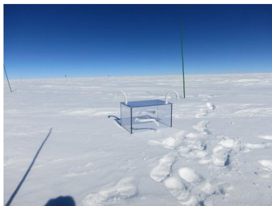
Fig AC3.03-1 - Area di campionamento delimitata dalle paline. Nella figura è presente il box trasparente in polipropilene usato per lo studio del comportamento del mercurio durante la degradazione/sublimazione del manto nevoso superficiale
