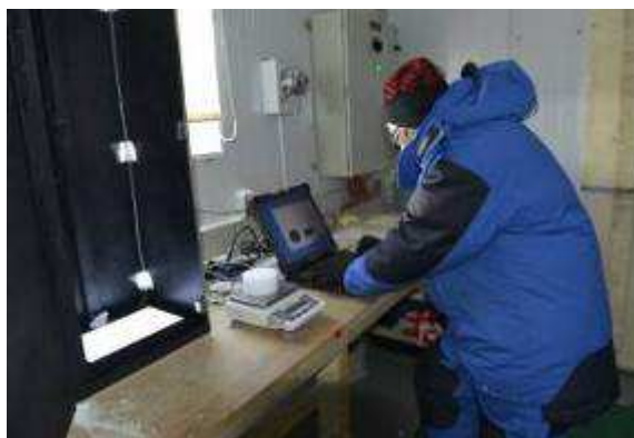
Photo 2 : Mesure de la masse d'un échantillon (cylindre de 5cm de hauteur)
