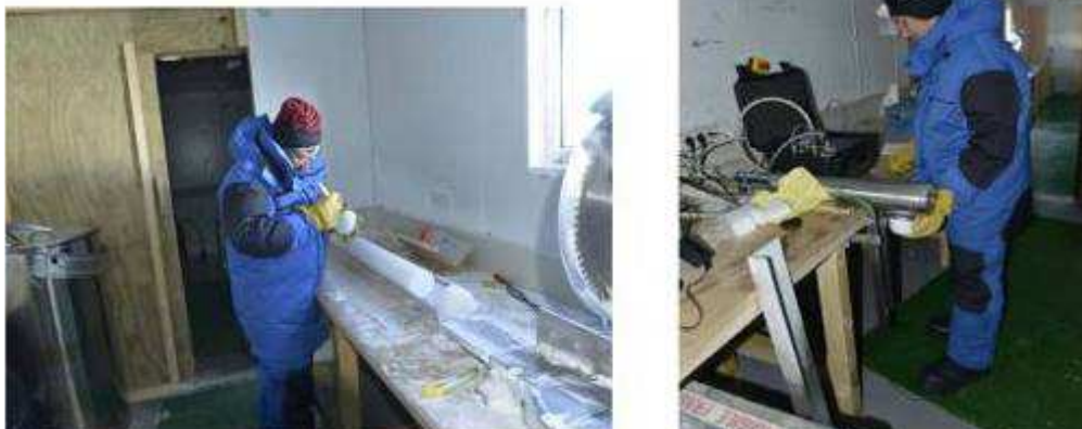
Photo 3 et 4 : Protocole de mesure de la taille de grains (SSA). Figure de gauche, nettoyage des échantillons pour enlever les copeaux dus à la découpe à la scie. Figure de droite, échantillon positionné sous les diodes de l'instrument Posssum.
