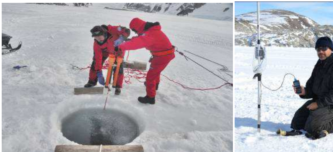
Foto 2 – Posizionamento delle trappole di sedimentazione (sinistra) e lettura di temperatura negli strati di ghiaccio (destra).
