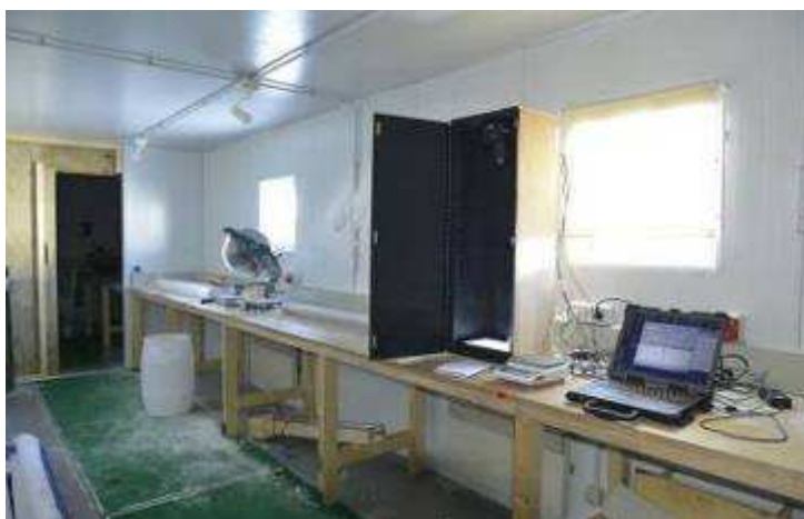
Photo 1 : Dispositif expérimental pour les mesures de densité. A l'arrière plan, la scie permettant un échantillonnage des carottes tous les 5cm. L'appareil photo placé dans le coffret central permet l'acquisition des dimensions des échantillons et la balance leur masse, dont on déduit la densité. Les données sont acquises et stockées sur PC.
