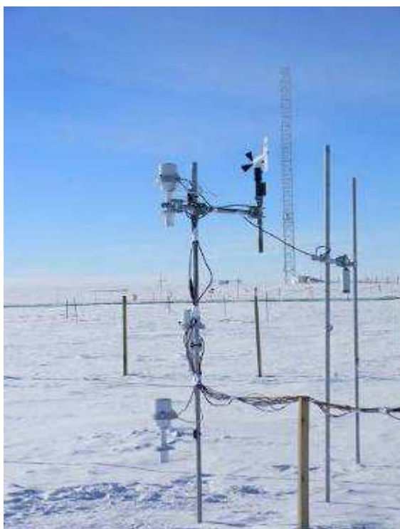
Profilage météorologique de surface ré-installé à proximité du shelter neige. Ce profilage permet de prolonger vers la surface celui de la tour visible en fond d'image.
