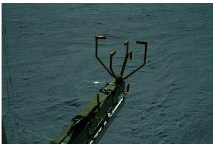
Le thermoanémomètre sonique ré-installé sur la tour.
