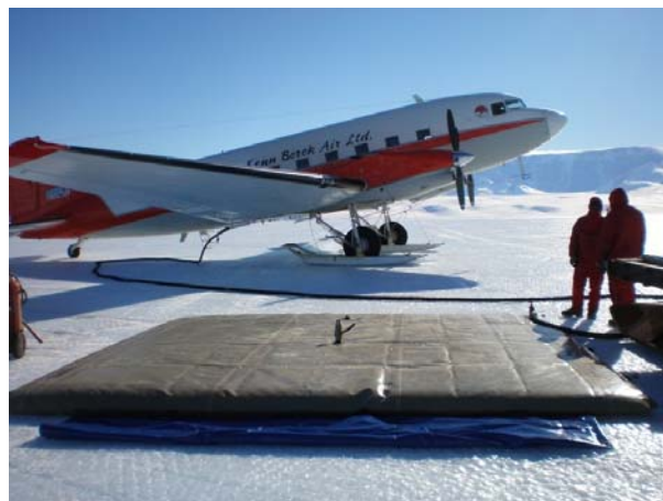
Riempimento del serbatoio collassabile effettuato con lo scarico del combustibile dall'ala del Basler
